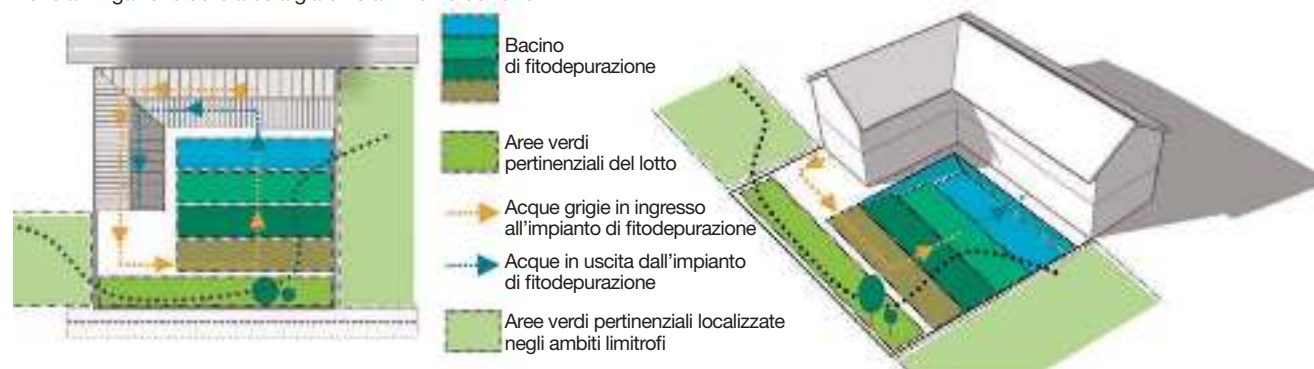
Raccolta e trattamento naturale delle acque grigie in provenienza dagli scarichi domestici , al fine di consentirne il re-utilizzo per funzioni secondarie. Le aree vegetate dell'impianto si caratterizzano anche come fasce di continuità per le reti ecologiche locali.
