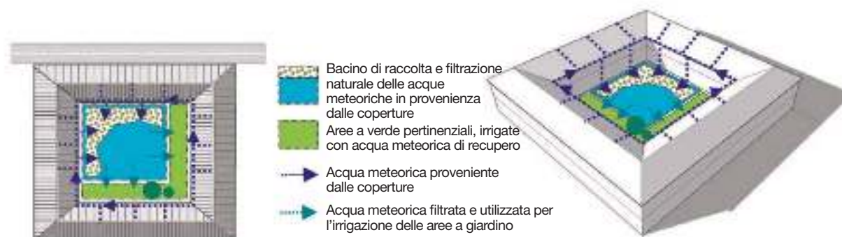
Raccolta e trattamento naturale delle acque piovane in provenienza dalle coperture , per consentirne il re-utilizzo anche in relazione all'irrigazione delle aree a giardino all'interno del lotto.
